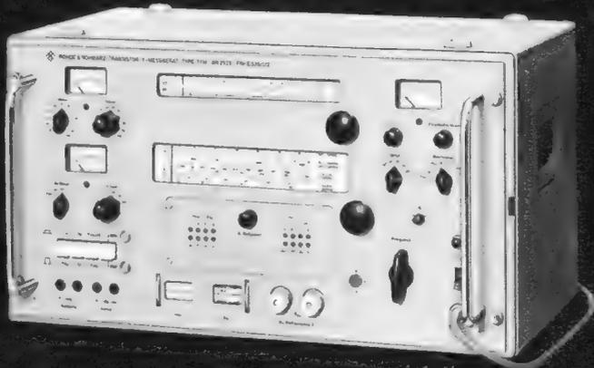
Dieses Gerät mißt die komplexen Parameter in Emitterschaltung bei den Festfrequenzen 0,02/0,1/0,5/1,65/5,5/10,7/21,4/36,6 MHz. Transistor-Arbeitspunkte:  $U_{CS} = 0,3 \dots 100 \text{ V}$ ,  $I_C = 10 \mu\text{A} \dots 100 \text{ mA}$ . Kleinste Meßbereiche für  $I_{CBO}$  und  $I_{EBO}$  sind  $30 \mu\text{A}$ . Mit Hilfsgeräten ist die Phase der Steilheit zu ermitteln. Kapazitätsdioden können ausgemessen werden.
