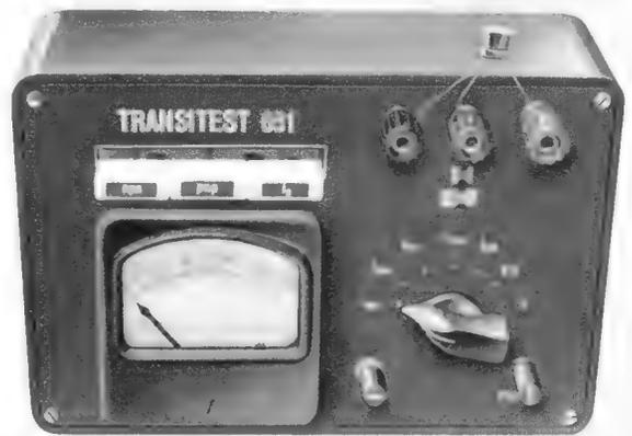
Rechts: Bild 1. Das handliche Transistorprüfgerät Transitest 651 läßt sich leicht nachbauen
